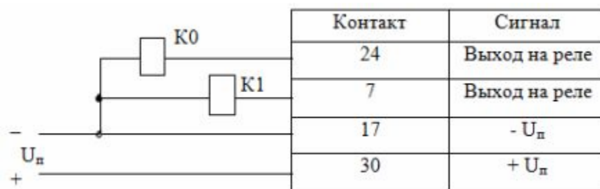
Рис.11. Схема подключения катушек реле
