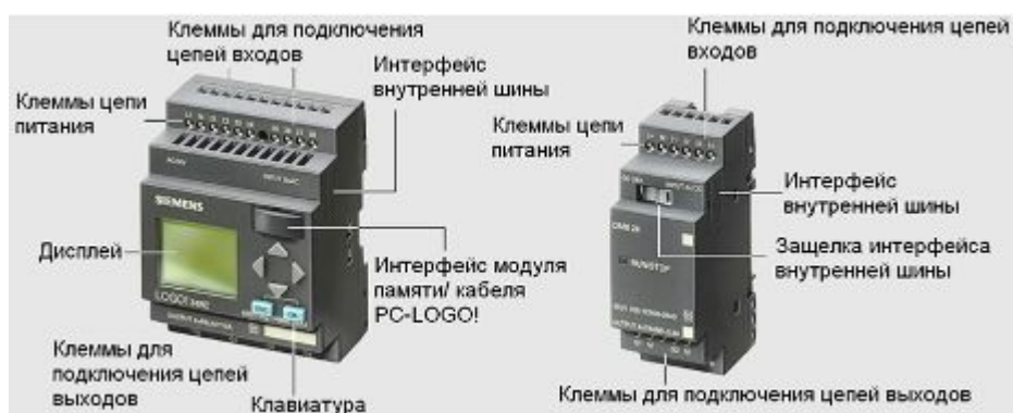
Рис.15 – Конструкция контроллера LOGO! Basic и модуля расширения
